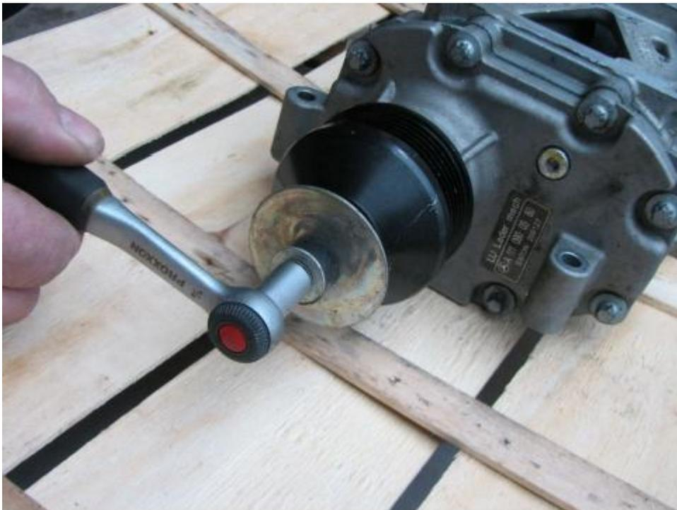
Paso 10. Utilice una mano para sujetar el volante y atornilla el perno.
