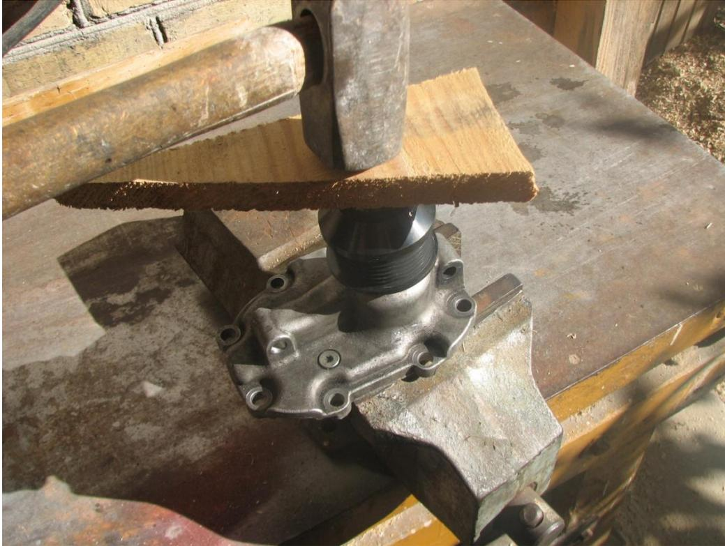
Si prefieres otra instalación de la polea, ve al paso 8, aunque la instalación presentada anteriormente es más fácil.
