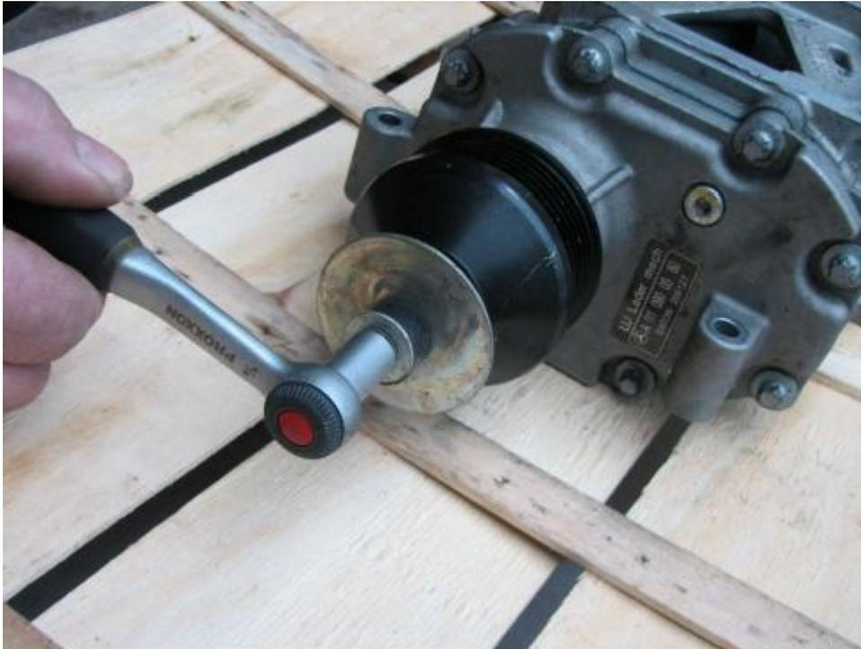
Schritt 10. Verwende eine Hand um das Rad festzuhalten und schraube die Schraube ein.
